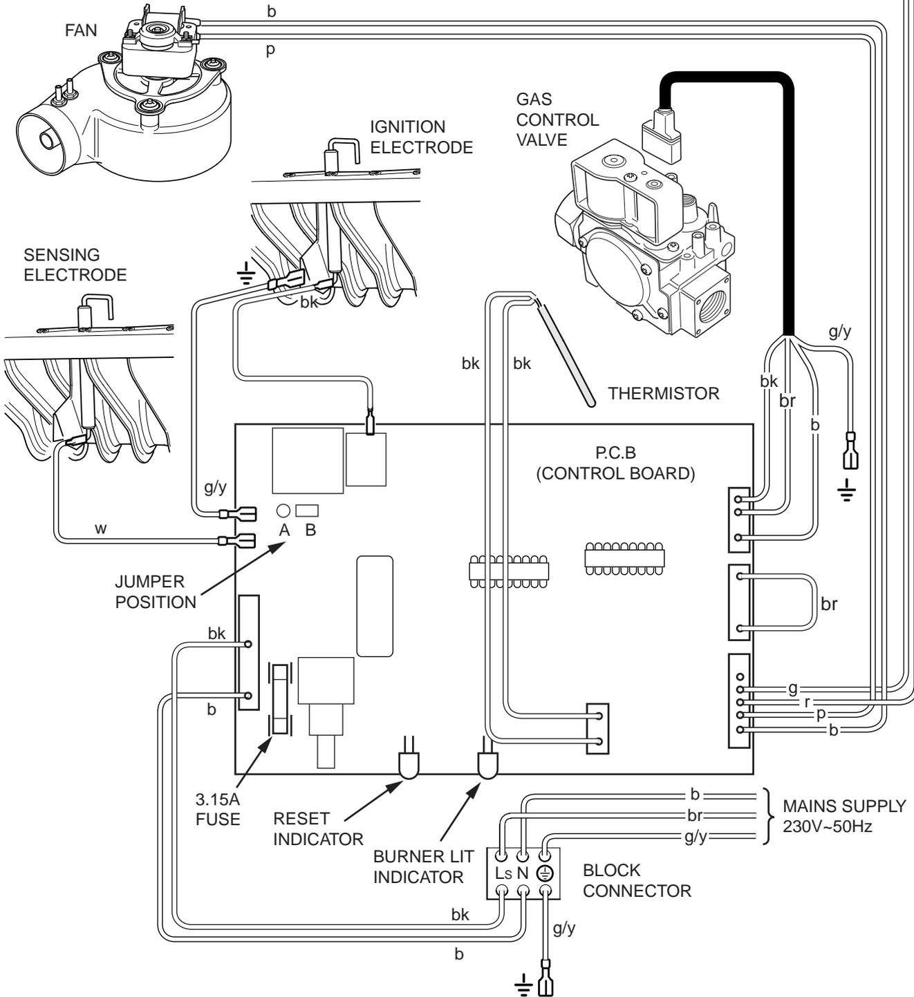
**BOILER PILOT FAULT FINDING**
