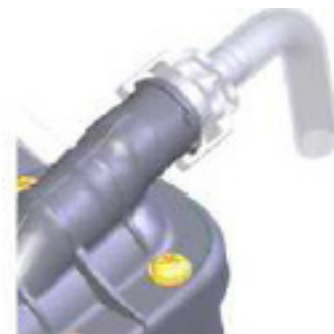
FIGURE 9-5 Soupape d'évacuation mécanique, sommet de l'échangeur thermique
