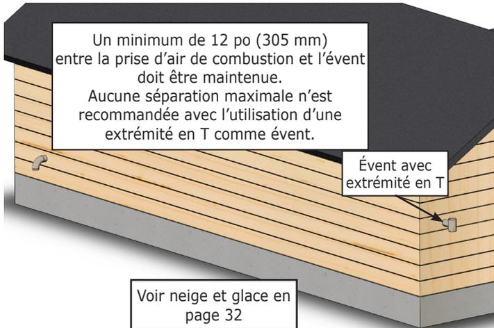
**Remarque** Les configurations avec tuyau d'évent unique à évacuation latérale nécessitent un té à l'extrémité. Voir les figures 6-17, 6-19 et 6-21.
