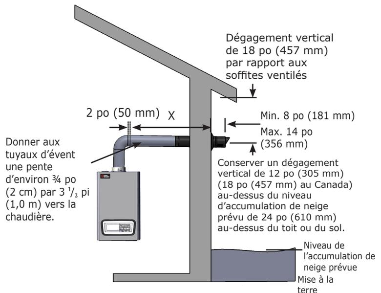
**FIGURE 6-3 Événement concentrique pour installation sur le toit**
