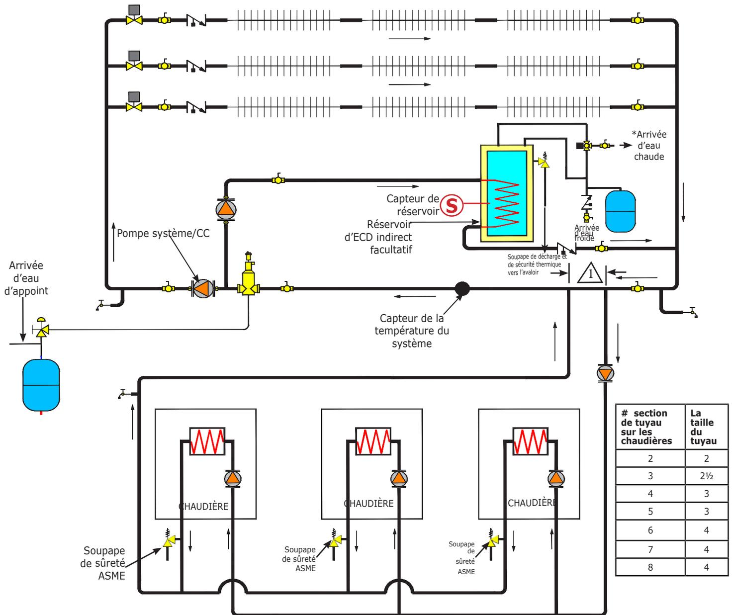
**Remarque** ➔ \* Le fabricant exige que toutes les installations d'eau chaude à usage domestique (ECD) utilisent un dispositif mitigeur. Les codes locaux peuvent exiger de l'équipement supplémentaire (vase d'expansion, soupapes de sûreté, etc.) Sélectionner et dimensionner l'équipement pour convenir à l'installation et respecter les exigences du code.
