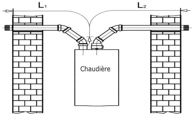
**FIGURE 6-10 Options d’installation d’extrémités d’évent horizontales séparées (évent Natalini seulement)**
