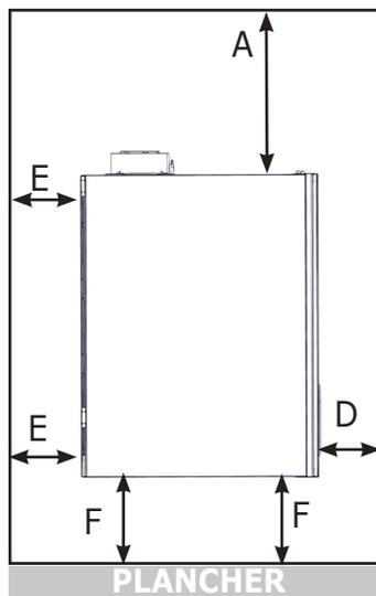
**FIGURE 4-2a Dégagement pour l'entretien, avant de la chaudière**
