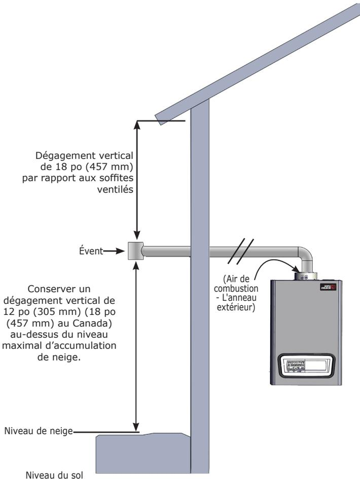
« Longueur des canalisations de ventilation et d’air de combustion » en page 26.
