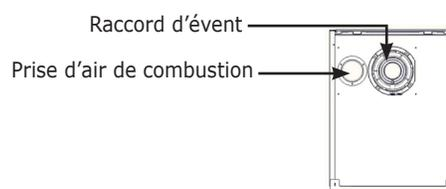
Vue de dessous Identification des raccordements
