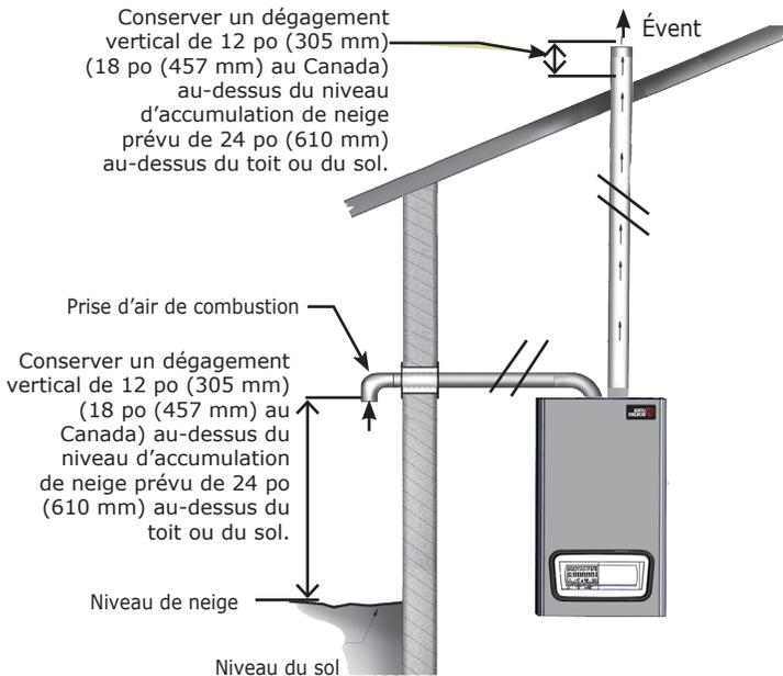
**Figure 6-19 Évacuation murale, prise d'air nécessaire à la combustion sur le toit**
