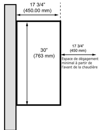
**FIGURE 4-2c Dégagement pour l'entretien, installation dans un placard**
