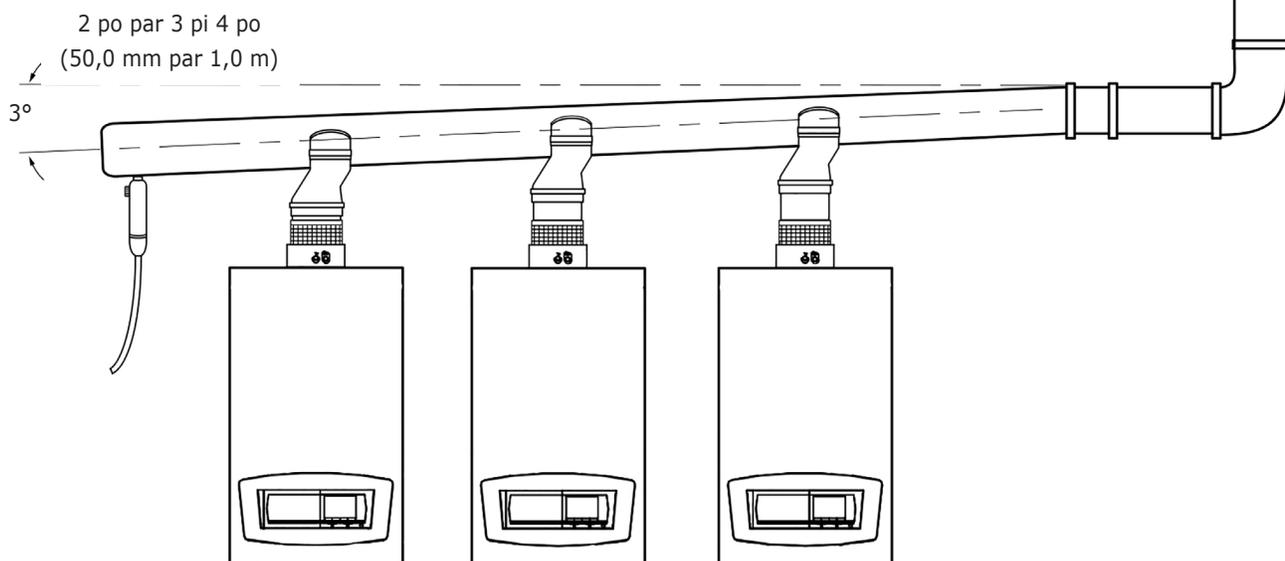
**6.12 Ventilation de plusieurs chaudières : configuration des paramètres**
