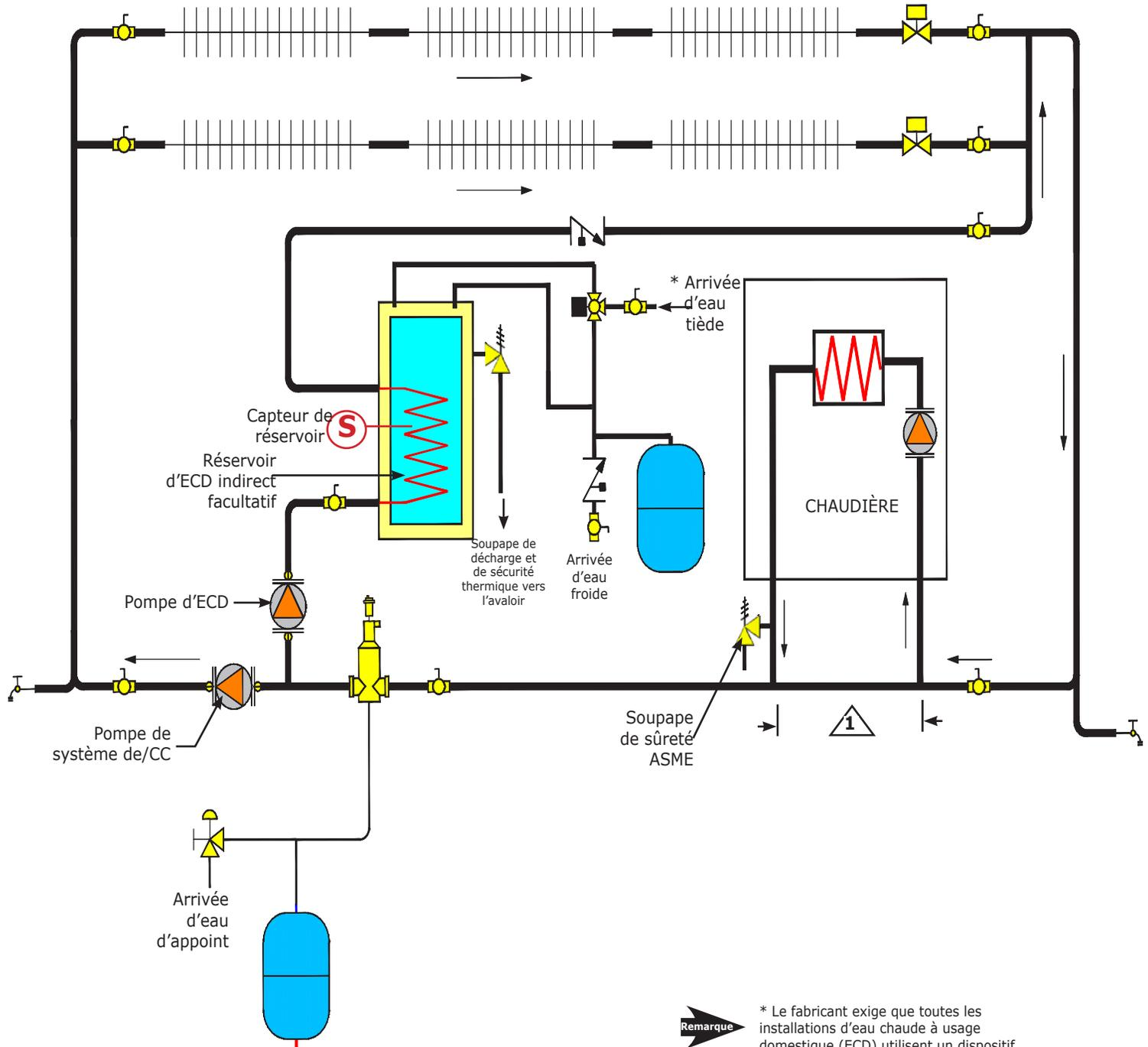
**Remarque** \* Le fabricant exige que toutes les installations d'eau chaude à usage domestique (ECD) utilisent un dispositif mitigeur. Les codes locaux peuvent exiger de l'équipement supplémentaire (vase d'expansion, soupapes de sûreté, etc.) Sélectionner et dimensionner l'équipement pour convenir à l'installation et respecter les exigences du code.
