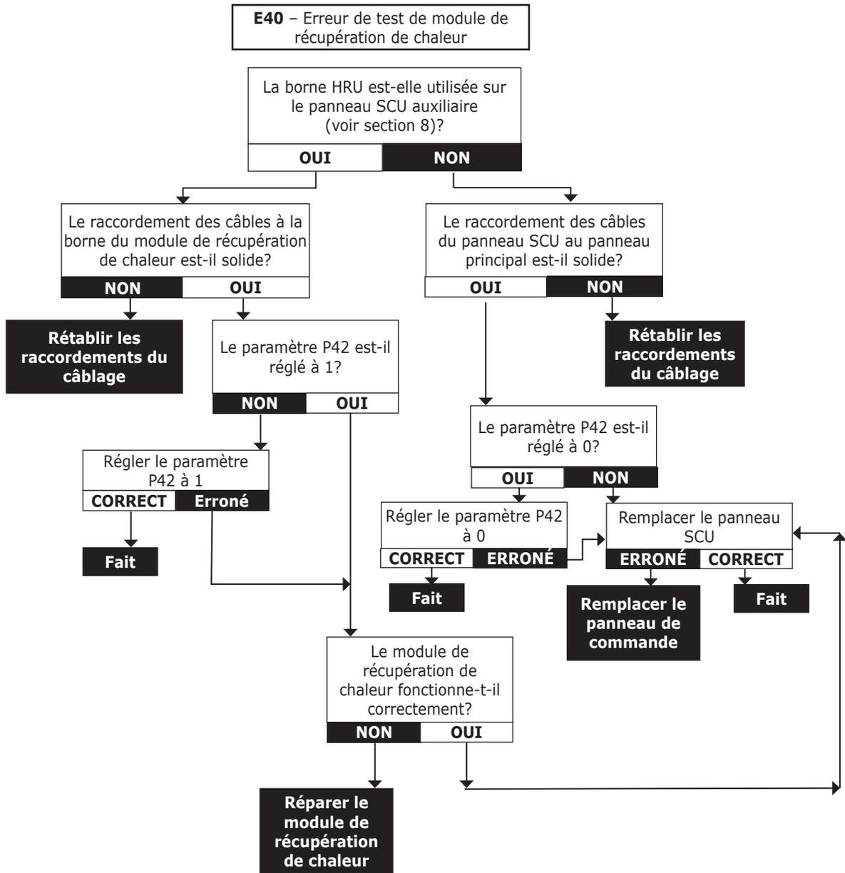
**Remarque :** Ce code d'erreur fait référence à l'interrupteur manométrique intégré et non à un dispositif d'arrêt en cas de faible niveau d'eau installé sur le terrain.
