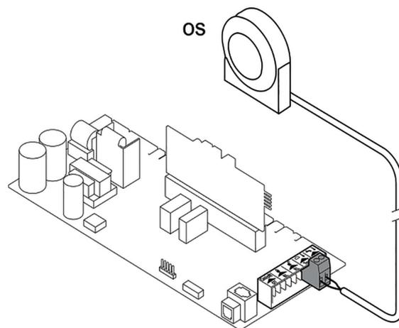
**FIGURE 8-11** Tableau du capteur de température extérieure
