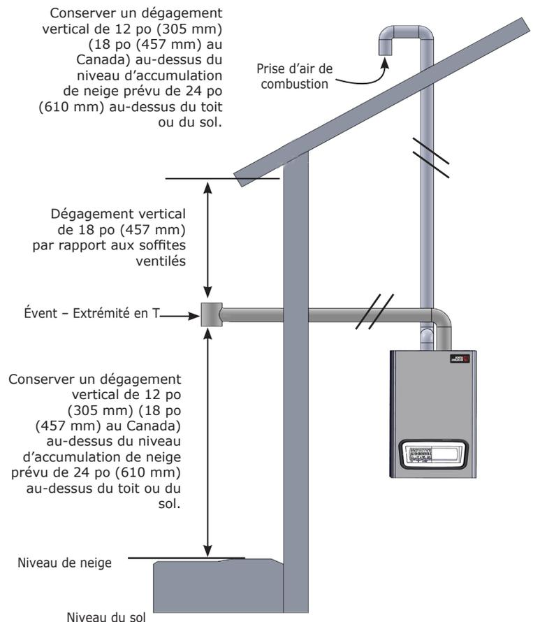
**FIGURE 6-20 Évacuation sur le toit, prise d’air nécessaire à la combustion**
