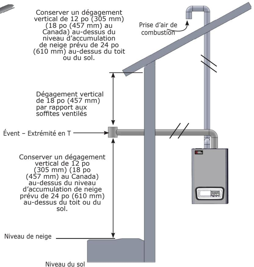
**FIGURE 6-12 Évacuation sur le toit, prise d'air nécessaire à la combustion**
