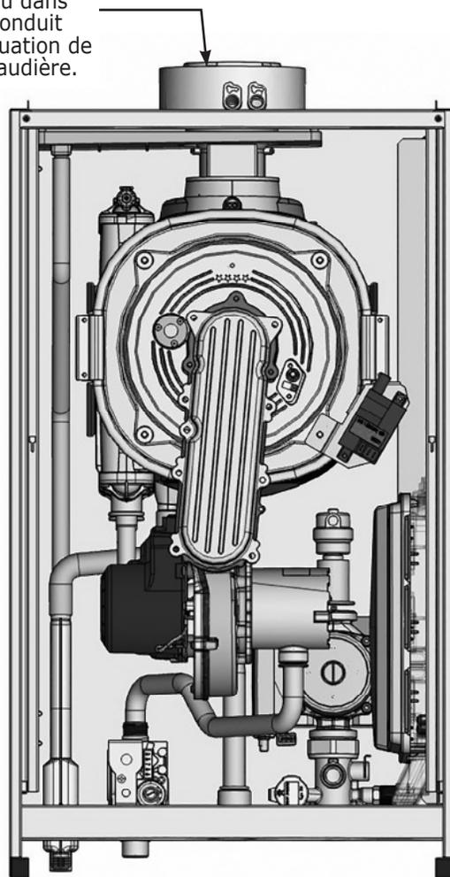
Tuyau d'écoulement de la condensation
