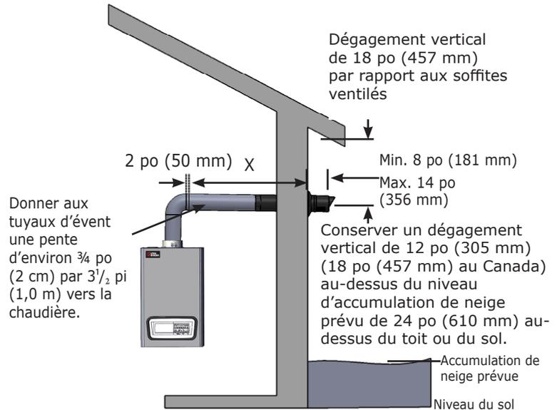
**FIGURE 6-2 Événement concentrique pour installation sur le toit**
