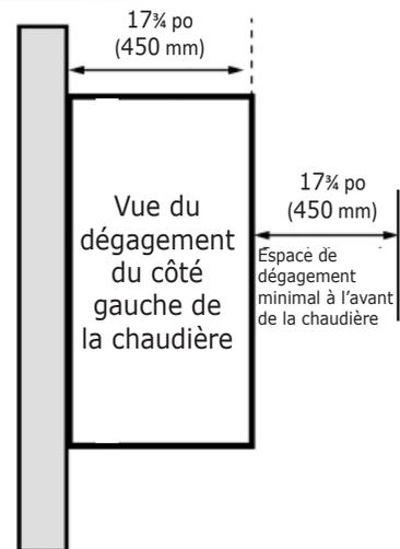
**FIGURE 4-2c Dégagement pour l'entretien, installation dans un placard**
