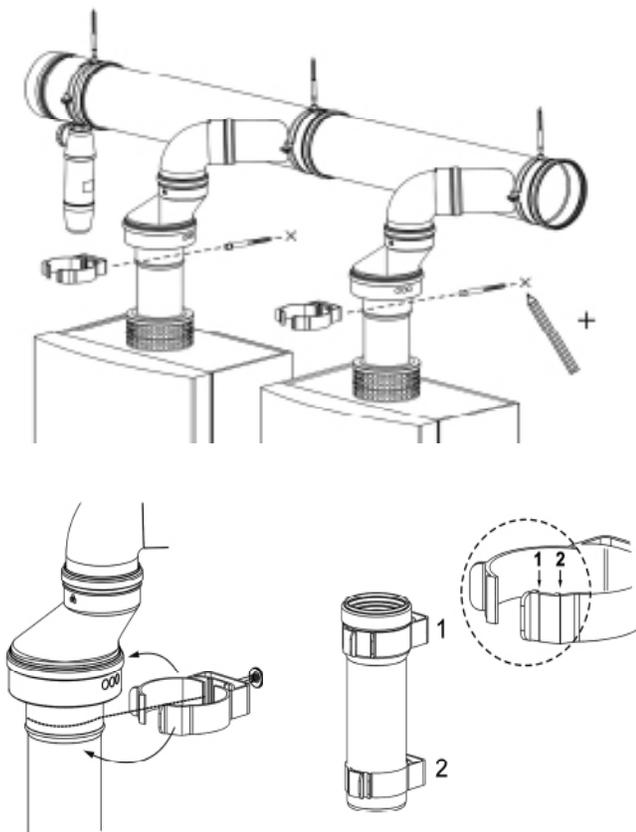
5. Raccorder le capuchon d’extrémité et le collecteur de condensats au tuyau d’évent horizontal commun. Voir figure 6-22.
