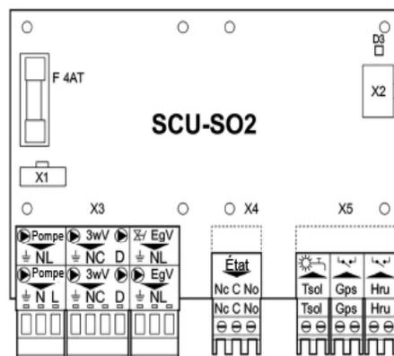
**1. Commande de pompe externe de chauffage central :** la pompe externe du système de chauffage peut être raccordée aux bornes du panneau de commande. La tension maximale d'alimentation est 300 VA/0,4 fractionnaire. Le relais auxiliaire doit être utilisé pour les pompes avec une puissance supérieure.
