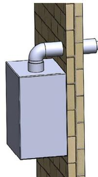
2. **Tuyau double** – Figure 6-2 Les tuyaux d’évacuation et d’entrée d’air sont séparés. Ils peuvent être terminés par des sorties simples dans le mur selon la configuration utilisée par le fabricant ou celle construite sur place à l’aide de coudes et de tés.
