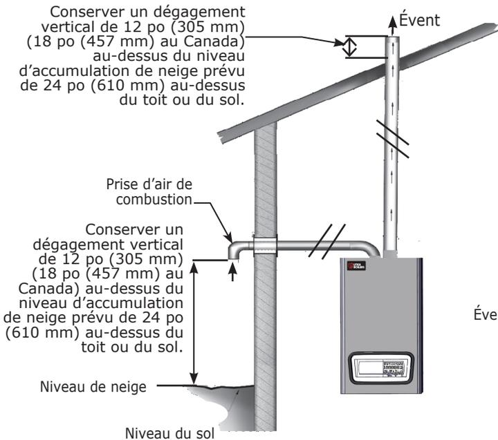
**Figure 6-11 Évacuation murale, prise d'air nécessaire à la combustion sur le toit**
