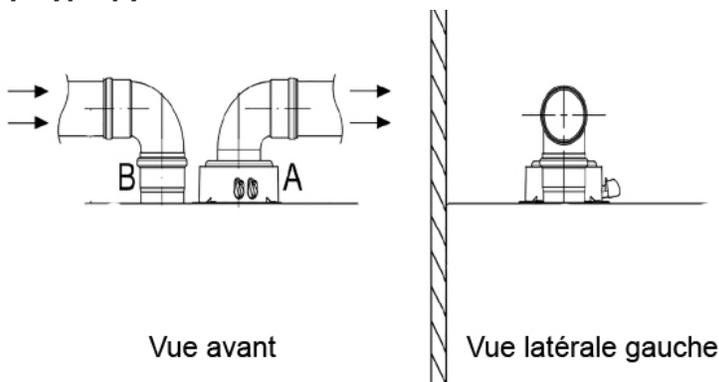
**FIGURE 6-4 Options d’installation d’extrémités d’évent horizontales séparées**
