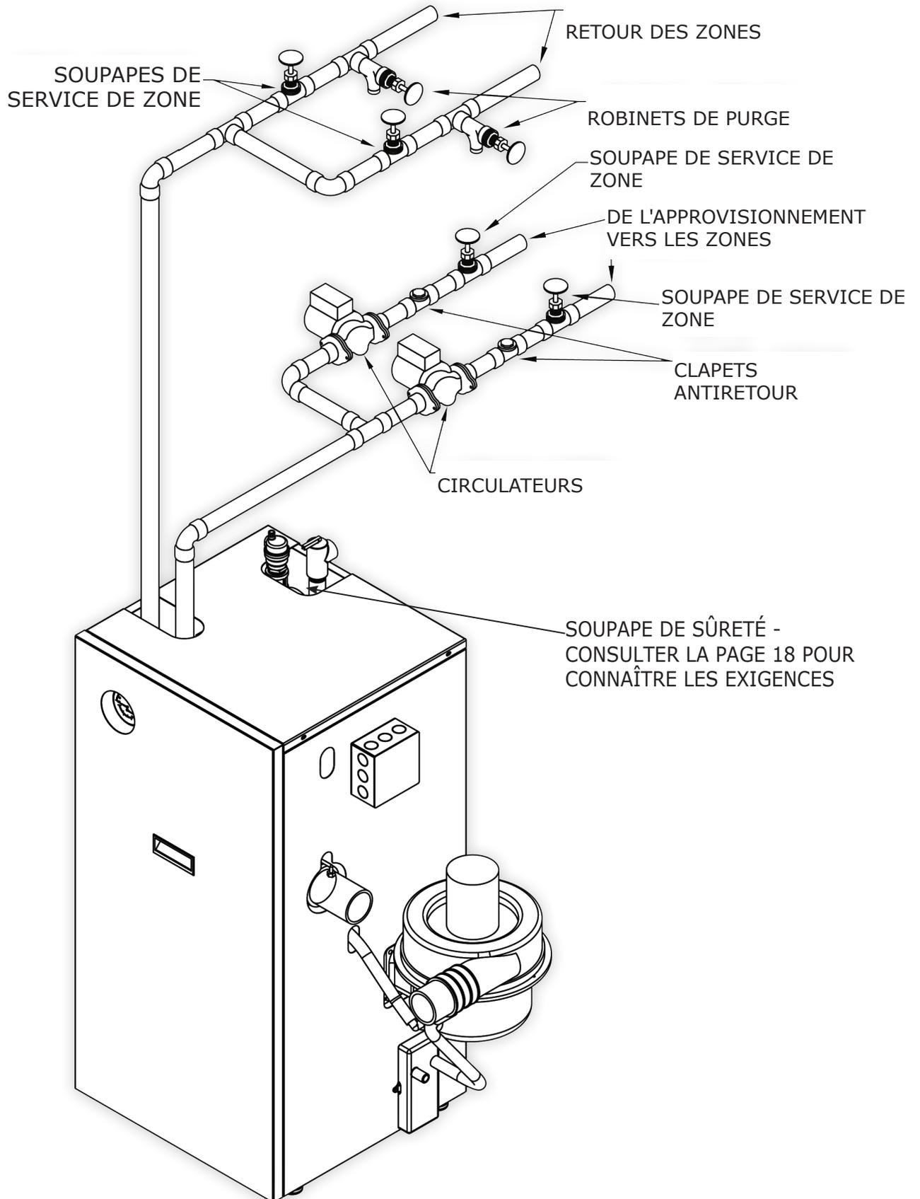
**Figure 6 - Canalisation principale/secondaire avec circulateurs et eau chaude à usage domestique**
