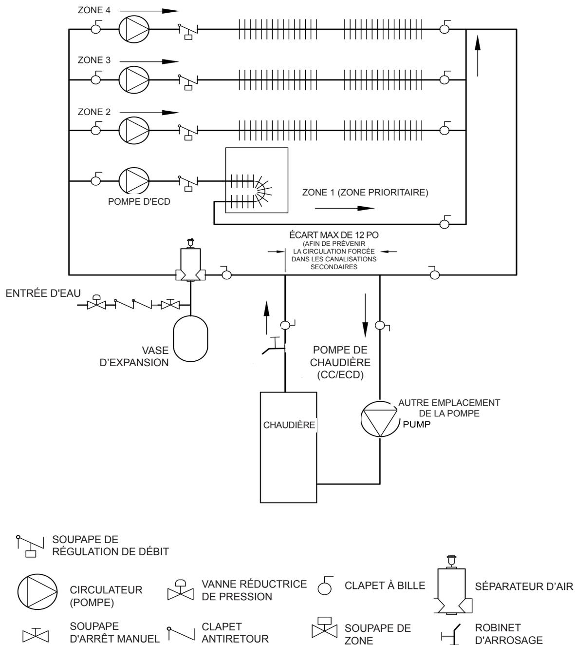
**Figure 7 - Canalisations principales et secondaires de système à zone multiples
