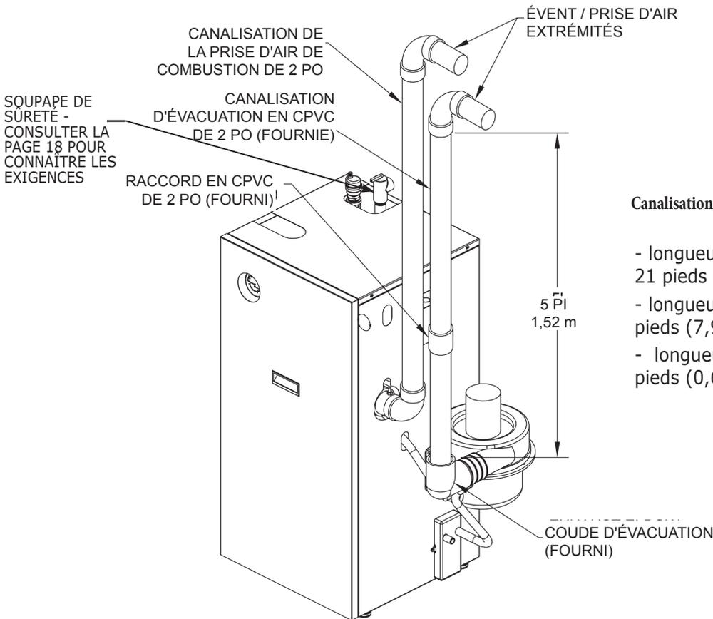
**Canalisation de la prise d'air de combustion et de l'évènement d'un diamètre de 2 po (50,8 mm)**
