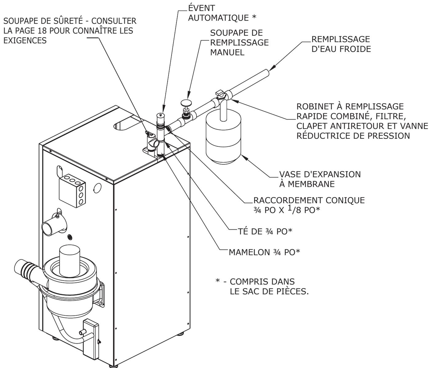
Figure 11 - Raccordements du vase d'expansion fermés conventionnels
