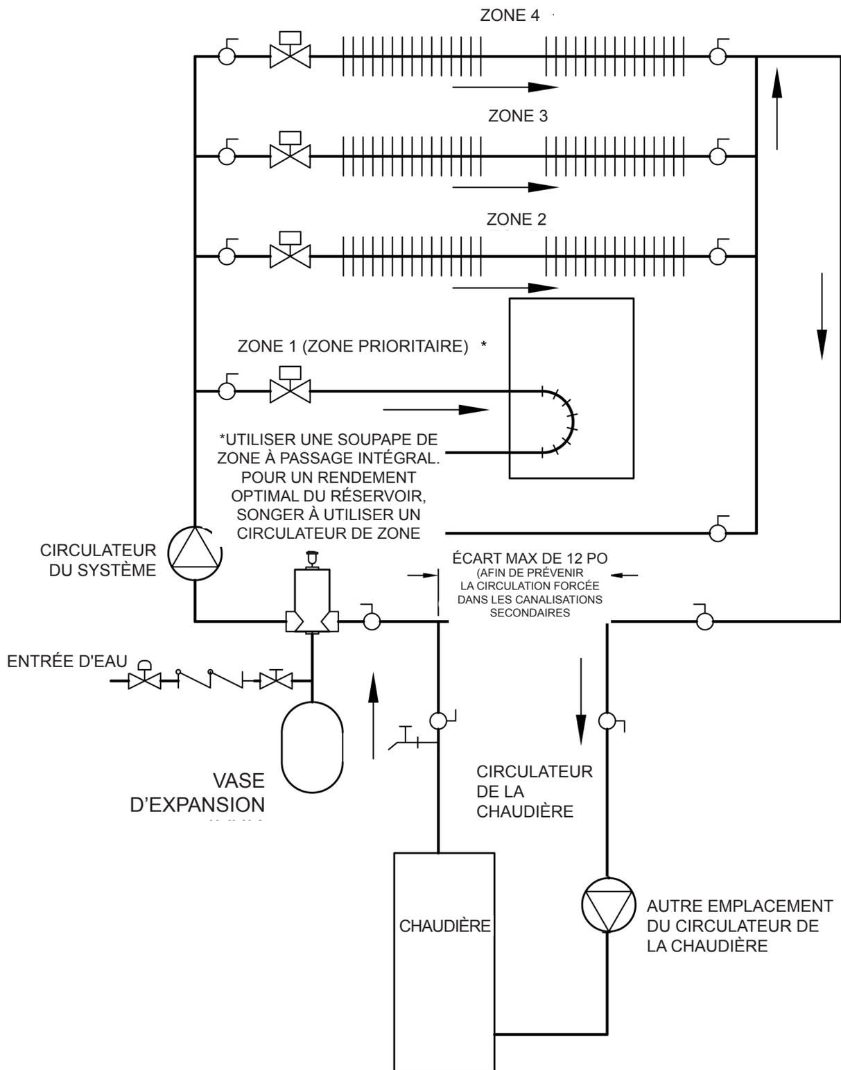
**Figure 8 - Canalisations principales et secondaires; canalisations avec soupapes de zone et eau chaude domestique (avec circulateur)**
