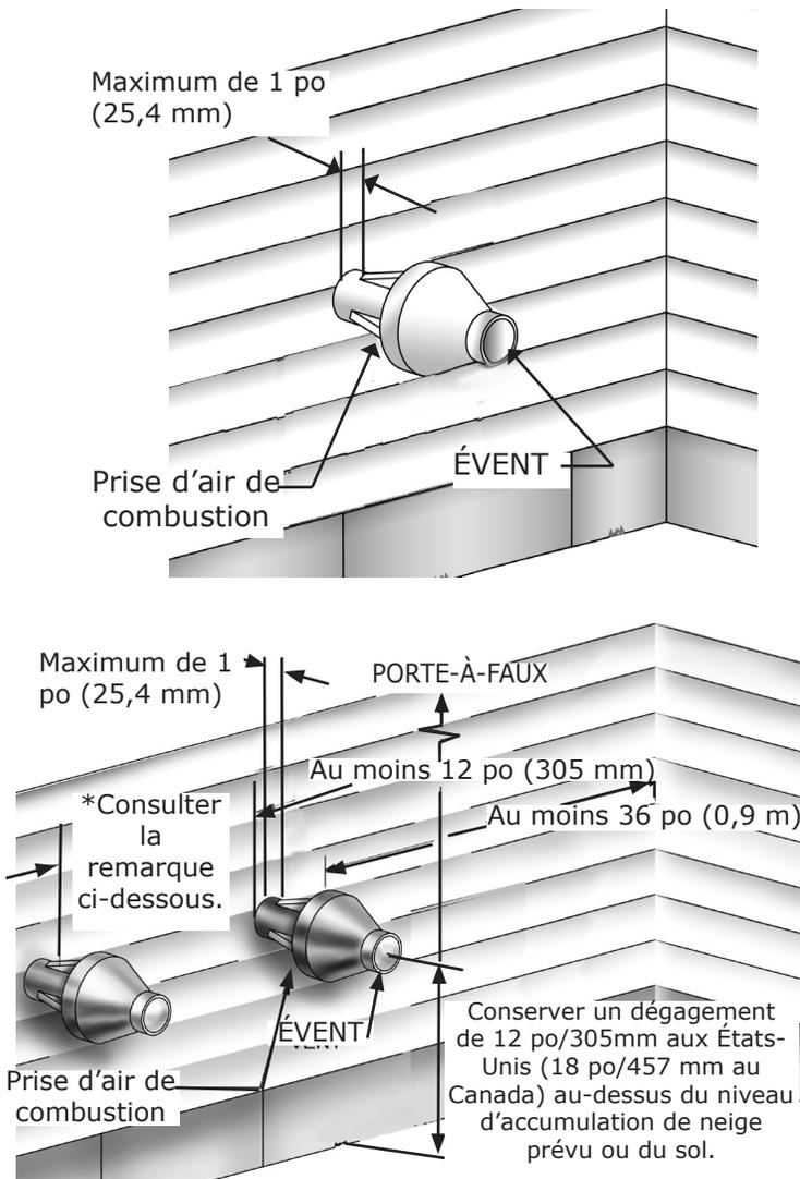
\*Une distance horizontale inférieure à 4 po (102 mm) ou supérieure à 24 po (610 mm) est requise entre chaque extrémité de prise d'air afin de prévenir la recirculation des résidus de combustion.
