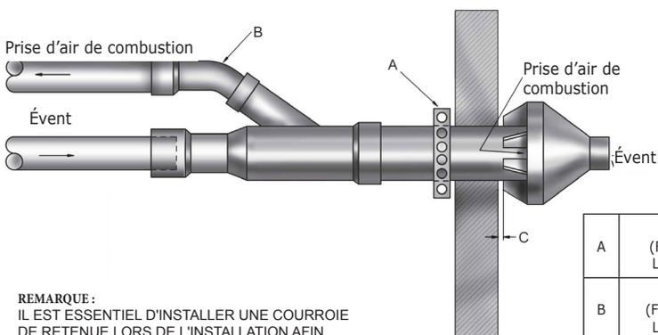
REMARQUE : IL EST ESSENTIEL D'INSTALLER UNE COURROIE DE RETENUE LORS DE L'INSTALLATION AFIN DE PRÉVENIR LES MOUVEMENTS DU SYSTÈME D'ÉVACUATION DANS LE MUR LATÉRAL.
