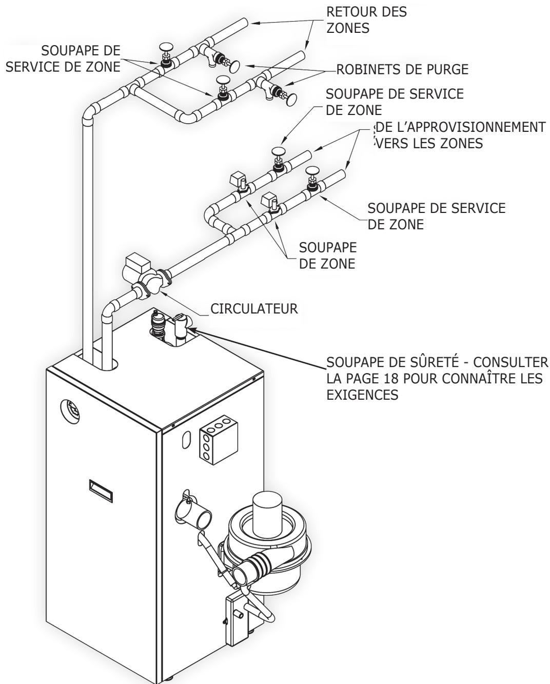
Figure 5 - Canalisations à deux zones de la chaudière avec soupapes de zone
