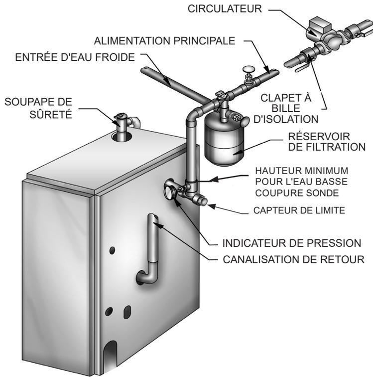
Figure 4 - Canalisations type d'un système à eau chaude forcée comprenant une soupape de commande de zone
