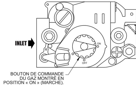
6. Enfoncer légèrement le bouton de commande du gaz et tourner dans le sens horaire jusqu'à la position « OFF » (ARRÊT).
