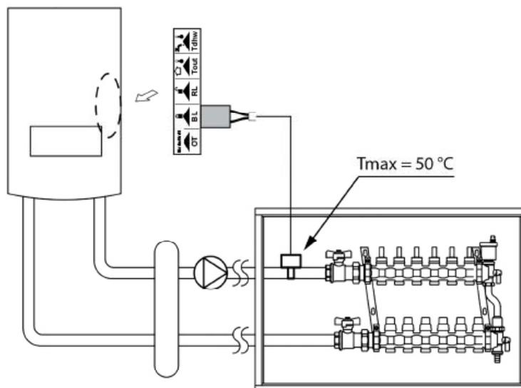
FIGURE 8-16 Schéma du circuit électrique
