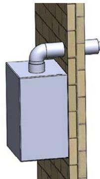
2. **Tuyau double** – Les tuyaux d'évacuation et d'entrée d'air sont séparés. Ils peuvent être terminés par des sorties simples dans le mur selon la configuration utilisée par le fabricant ou celle construite sur place à l'aide de coudes et de tés.
