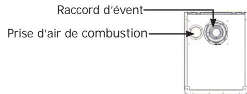
**Vue de dessous Identification des raccordements**
