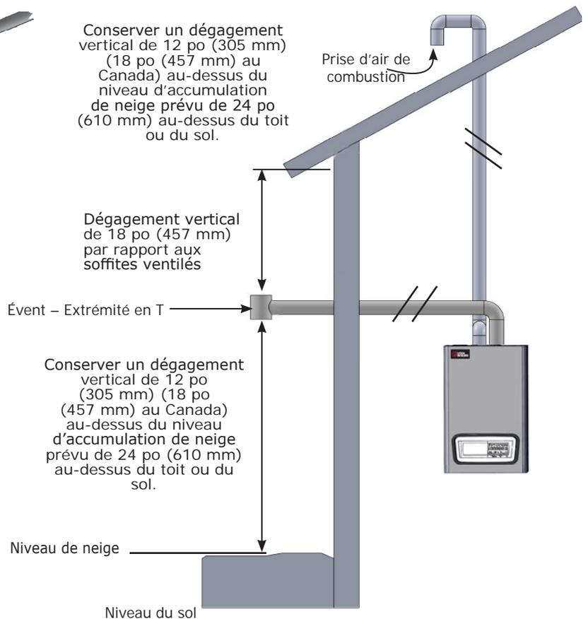
**FIGURE 6-13 Évacuation sur le toit, prise d'air nécessaire à la combustion**
