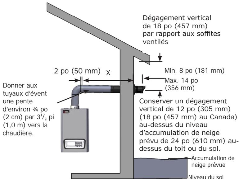
**FIGURE 6-3 Évent coaxial pour installation sur le toit**
