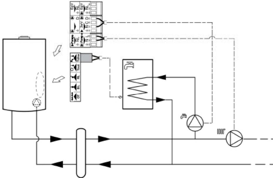
**FIGURE 8-15 Exemple de raccordement du signal d'arrêt du système**
