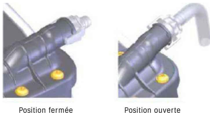
FIGURE 9-5 Soupape d'évacuation mécanique, sommet de l'échangeur thermique
