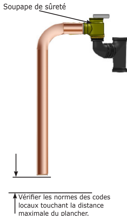
FIGURE 5-2 Canalisations du système : emplacement de la sonde de l'interrupteur en cas de faible niveau d'eau
