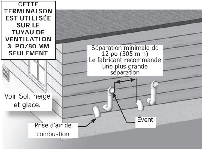
**FIGURE 5-18 – (3 po/80 MM SEULEMENT) ÉVENT LATÉRAL DE TUYAU DOUBLE AVEC ANGLE DE 45°**
