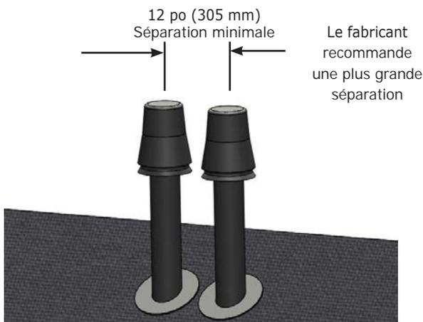
**FIGURE 5-6 – ÉVENT COAXIAL POUR MUR LATÉRAL** Peut Être Utilisé Sur Toutes les Grandeurs
