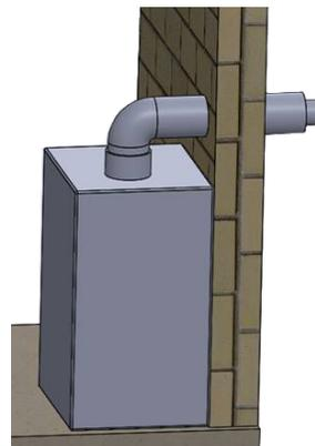
et d’entrée d’air sont séparés. Ils peuvent être terminés par des sorties simples dans le mur selon la configuration utilisée par le fabricant ou celle construite sur place à l’aide de coudes et de tés.
