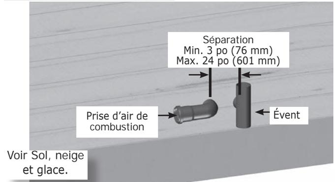
**FIGURE 5-23 - ((2 po/50 MM ET 3po/80MM)) LA BOUCHE DE CÔTÉ DE PIPE DE JUMEAU MURALE PEUT ÊTRE UTILISÉ SUR TOUTES LES GRANDEURS**
