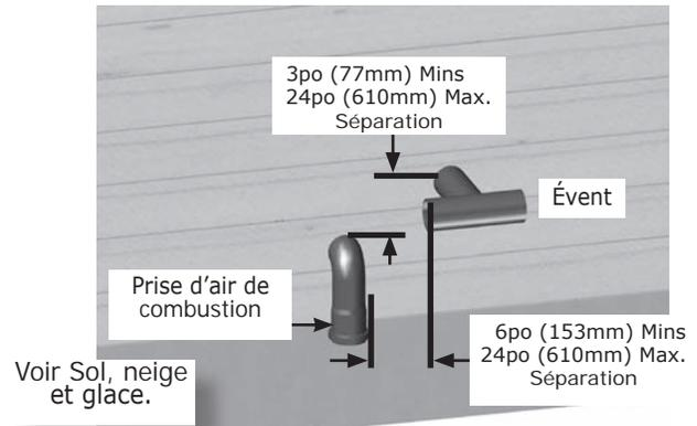
**FIGURE 5-21 - (2 po/50 MM ET 3po/80MM) PIPE DE BOUCHE W/HORIZONTAL T PEUT ÊTRE UTILISÉ SUR TOUTES LES GRANDEURS**
