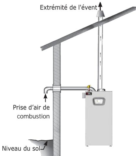
**FIGURE 5-13 – TUYAU DOUBLE D'ÉVACUATION SUR LE MUR LATÉRAL, PRISE D'AIR NÉCESSAIRE À LA COMBUSTION SUR LE TOIT PEUT ÊTRE UTILISÉ SUR TOUTES LES GRANDEURS**
