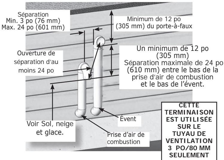
**FIGURE 5-20 - (2 po/50 MM ET 3po/80MM) PIPE DE BOUCHE W/HORIZONTAL T PEUT ÊTRE UTILISÉ SUR TOUTES LES GRANDEURS**
