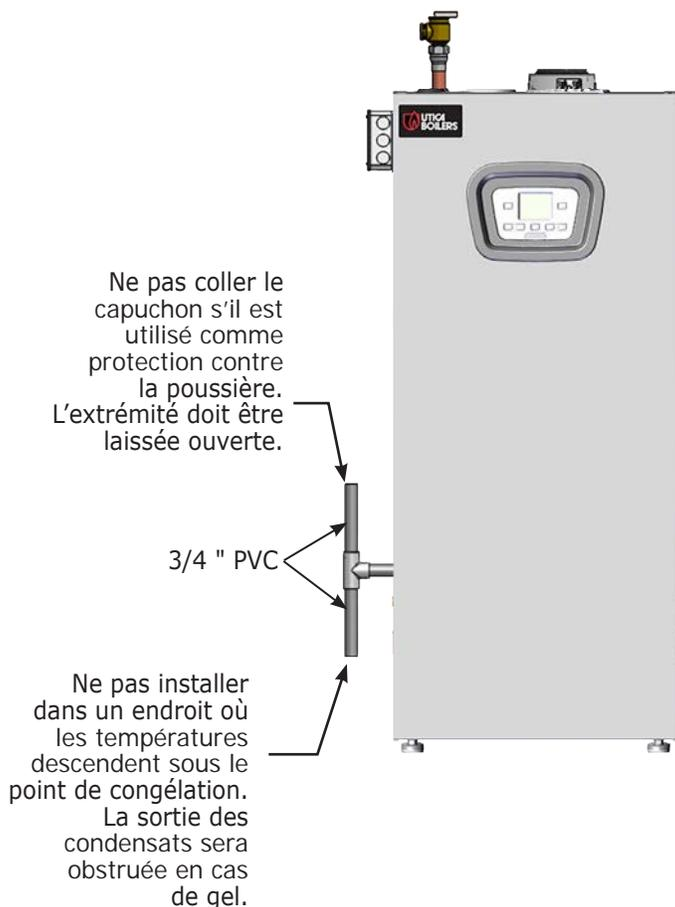
**5.11 Canalisations d'écoulement de la condensation**
