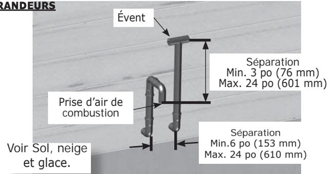
**FIGURE 5-22 - ((2 po/50 MM ET 3po/80MM)) LA BOUCHE DE CÔTÉ DE PIPE DE JUMEAU MURALE PEUT ÊTRE UTILISÉ SUR TOUTES LES GRANDEURS**
