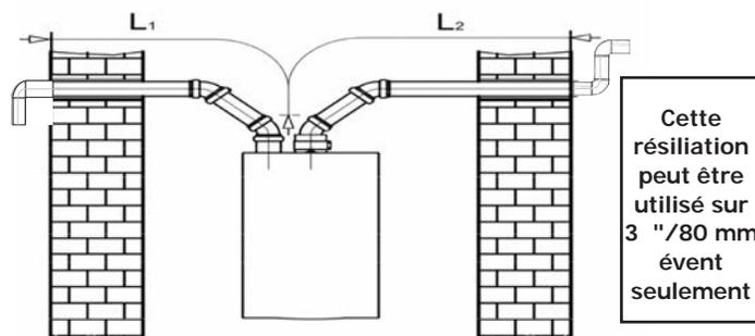
**FIGURE 5-10 - 2 po ET 3 po TWIN PIPE SÉPARÉE TUYAU D’ÉVACUATION HORIZONTALE AVEC TÉ SUR ÉCHAPPEMENT - PEUT ÊTRE UTILISÉ SUR TOUTES LES GRANDEURS**
