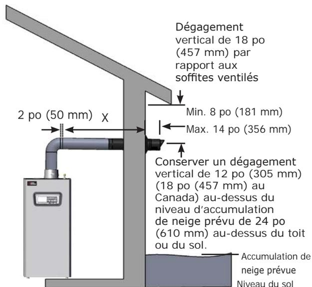
**FIGURE 6-3 – Évent coaxial pour installation sur le toit**
