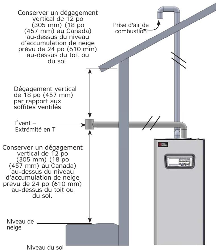
**FIGURE 6-13 Évacuation sur le toit, prise d’air nécessaire à la combustion**
