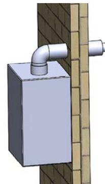
2. **Tuyau double** – Les tuyaux d'évacuation et d'entrée d'air sont séparés. Ils peuvent être terminés par des sorties simples dans le mur selon la configuration utilisée par le fabricant ou celle construite sur place à l'aide de coudes et de té.
