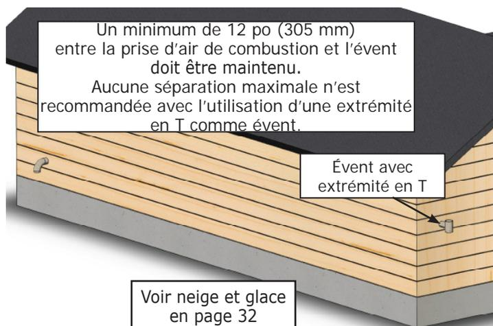
**Remarque** Les configurations avec tuyau d'évent unique à évacuation latérale nécessitent un té à l'extrémité. Voir les figures 6-10, 6-12 et 6-14.
