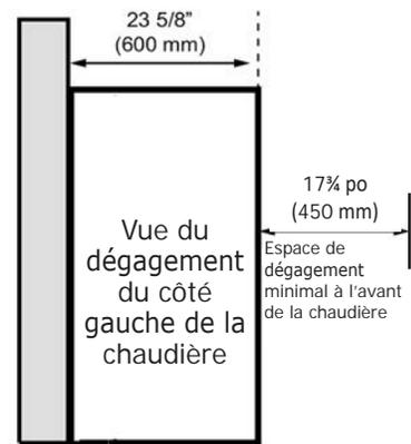
**FIGURE 4-2c Dégagement pour le combustible, installation dans un placard**
