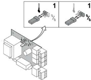
5. **Commande analogique basée sur la production de chaleur :** un signal de 0 à 10 V commande la production de chaleur de la chaudière, entre 0 % et 100 %. Les valeurs minimale et maximale sont limitées. La production minimale est liée à la profondeur de modulation de la chaudière. La production varie entre les valeurs minimale et maximale sur la base de la valeur déterminée par le régulateur.
