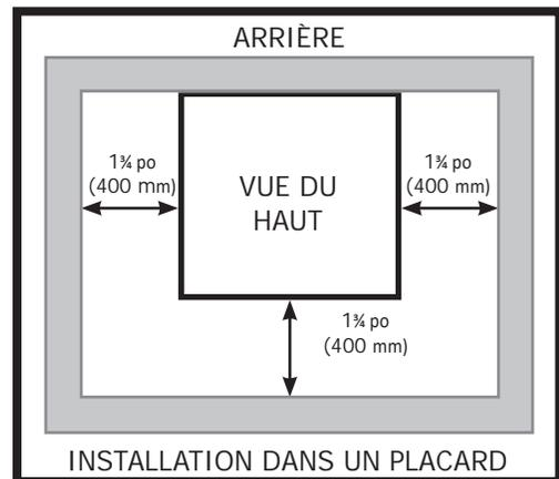
0 po / 0 mm entre l'arrière de l'appareil et le mur
