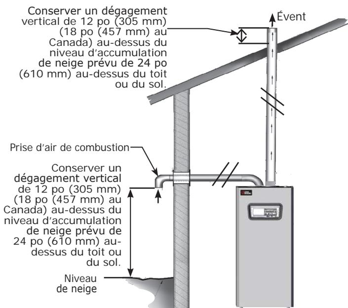
**Figure 6-12 Évacuation murale, prise d'air nécessaire à la combustion sur le toit**
