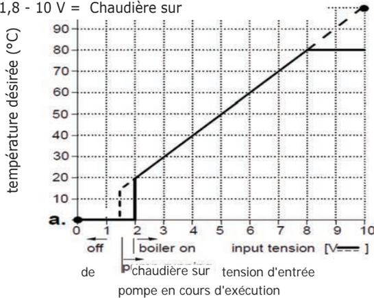
**FIGURE 8-7 Commande analogique basée sur la température**
