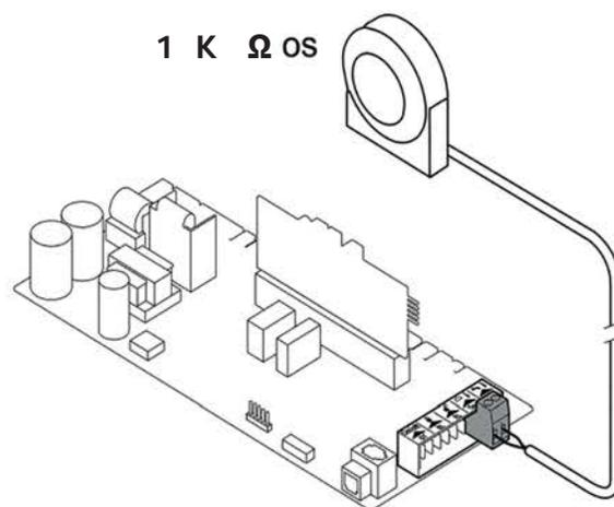
**FIGURE 8-11 Tableau du capteur de température extérieure 1k Ω**
