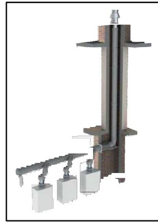
**FIGURE 6-27 – Utilisation de ventilation de chaudières multiples**
