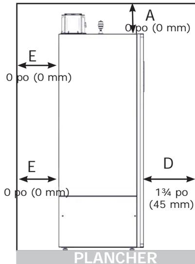
**FIGURE 4-2b Dégagement pour l'entretien, vue côté gauche de la chaudière**
