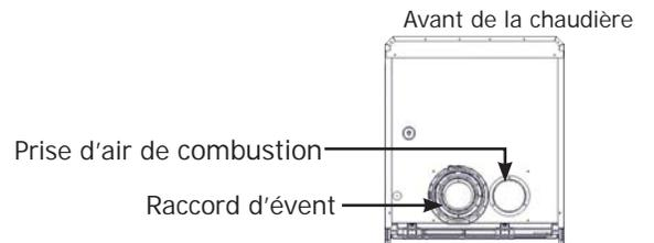
Vue de dessous Identification des raccordements
