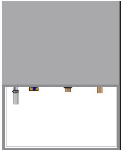
Ne pas installer dans un endroit où les températures descendent sous le point de congélation. La sortie des condensats sera obstruée en cas de gel.
