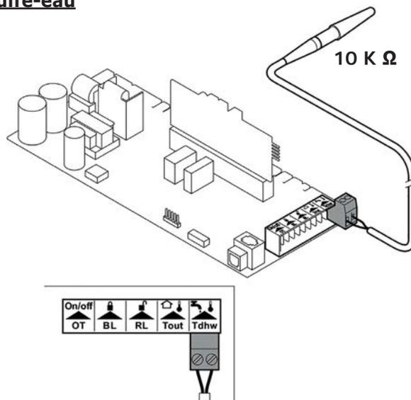
**FIGURE 8-13** Protection contre le gel combinée au thermostat de marche/arrêt.
