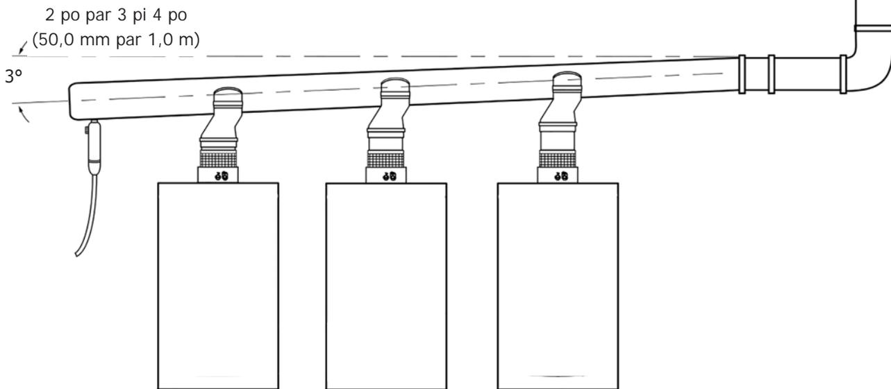
**6.13 Ventilation de plusieurs chaudières : configuration des paramètres**
