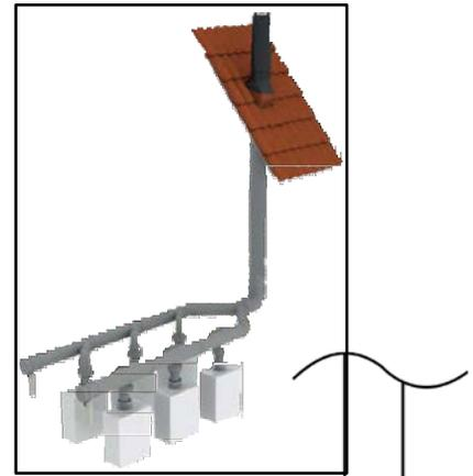
**FIGURE 6-29– Utilisation de ventilation de chaudières multiples**
