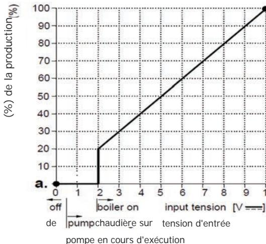
6. **Sortie analogique 0 à 10 V :** la température ou la production de chaleur peuvent être choisies pour ce message de rétroaction. Les deux commandes sont brièvement décrites ci-dessous. **Le cavalier 1** de l’interface sert à sélectionner la commande de température (🌡️) ou la commande de production de chaleur (%).
