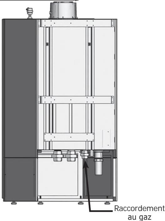
**Remarque** Utiliser deux (2) clés pour resserrer les accessoires et canalisations aux raccords filetés de la chaudière. Les canalisations internes de la chaudière peuvent être endommagées si elles sont exposées à une force excessive.
