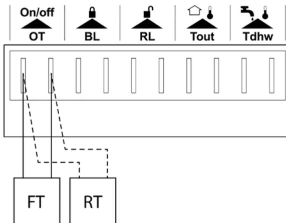
FIGURE 8-16 Schéma du circuit électrique
