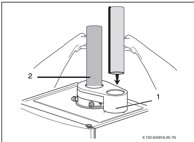
Fig. 23 Vent pipes
