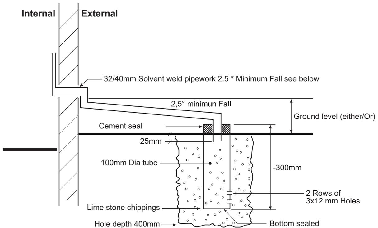
fig. 28 - Condensate drain
